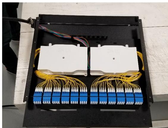
8. Asegure el cable de alimentación al soporte del cable de entrada usando las abrazaderas suministradas u otro medio acorde como cinchos.
